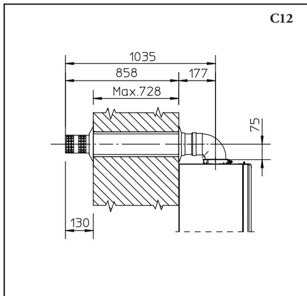
• Applicazione con uscita laterale; Utilizzando il solo kit orizzontale aspirazione-scarico, senza le apposite prolunghe, la distanza massima fra l'asse verticale di scarico e la parete esterna è di 905 mm.
