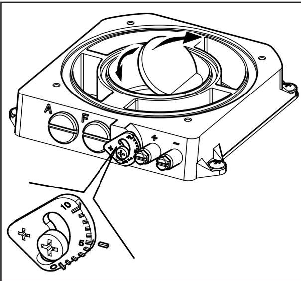
La regolazione si effettua svitando la vite frontale di fermo e spostando l'indicatore graduato sulla posizione corretta allineando il proprio valore al riferimento orizzontale (vedi figura precedente). Una volta fatta la regolazione stringere la vite per fissare il parzializzatore. La regolazione appropriata avviene in base al tipo di condotto e alla sua estensione: detto calcolo si può effettuare con l'utilizzo delle tabelle pag. 12.
