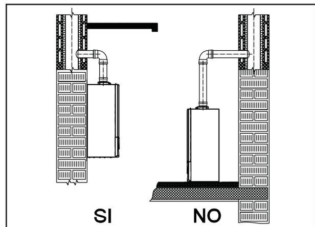
**Attenzione:** l'installazione della caldaia sulla parete, deve garantire un sostegno stabile ed efficace al generatore stesso.
