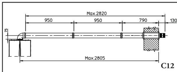
Collegamento con N°2 prolunghe. Max. distanza fra asse verticale caldaia e parete esterna mm 2805.
