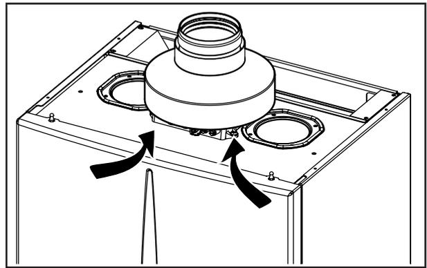
**Regolazione parzializzatore fumi.** Per un corretto funzionamento della caldaia in configurazione aspirazione diretta è necessario regolare il parzializzatore fumi spostando l'indicatore sulla tacca 5 (vedi pag. 9).
