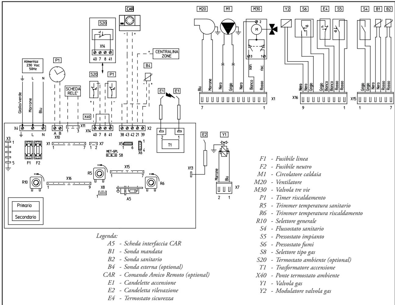
Comando Amico Remoto: la caldaia è predisposta per l'applicazione del Comando Amico Remoto (CAR) il quale deve essere collegato ai morsetti 42 e 43 del connettore X2 sulla scheda elettronica rispettando la polarità ed eliminando il ponte X40.
