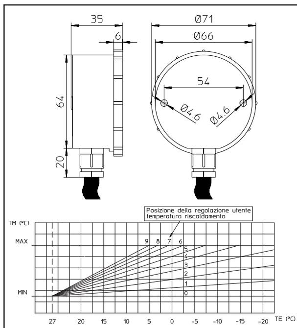
**Importante:** In caso di impianto suddiviso in zone il CAR deve essere utilizzato escludendo la sua funzione di termoregolazione climatica, ovvero impostandolo in modalità On/Off.
