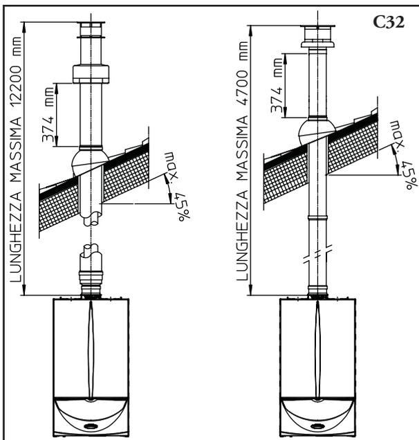
**Kit separatore Ø 80/80.** Il kit separatore Ø 80/80, consente di separare i condotti di scarico fumi e aspirazione aria secondo lo schema riportato in figura. Dal condotto (A) vengono espulsi i prodotti della combustione. Dal condotto (B) viene aspirata l'aria necessaria per la combustione. Il condotto di aspirazione (B) può essere installato indifferentemente a destra o sinistra rispetto al condotto centrale di scarico (A). Entrambi i condotti possono essere orientati in qualsiasi direzione.
