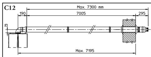
**N.B.:** durante l'installazione dei condotti è necessario installare ogni 3 metri una fascetta rompitratta con tassello.
