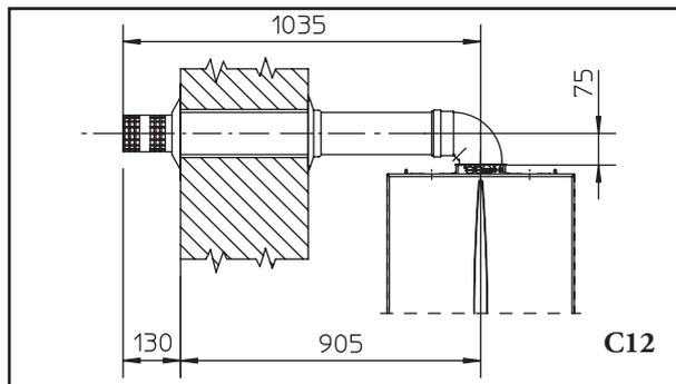
• Prolunghe per kit orizzontale. Il kit orizzontale di aspirazione -scarico Ø 60/100 può essere prolungato fino a una misura max. di 3000 mm orizzontali, compreso il terminale grigliato ed esclusa la curva concentrica in uscita dalla caldaia. Tale configurazione corrisponde ad un fattore di resistenza uguale a 100. In questi casi è necessario richiedere le apposite prolunghe.
