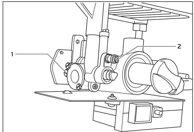
Fig. 6.2 Bocchettone per la misurazione della pressione di allacciamento del gas (è raffigurato il tipo GX)
