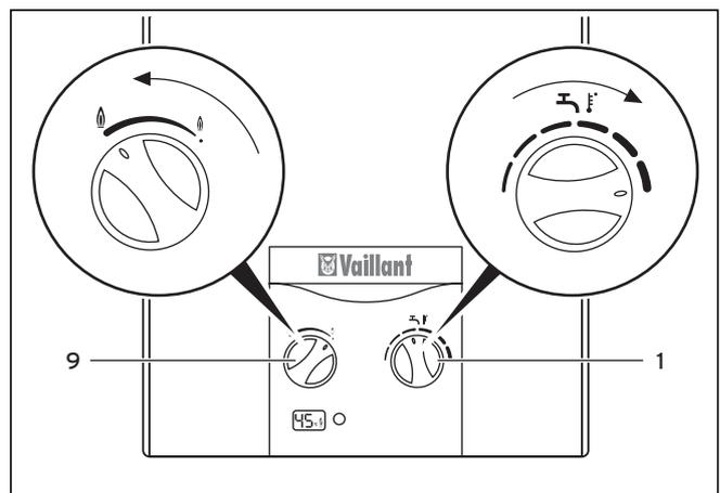
Fig. 5.3 Impostazione della massima temperatura e potenza
