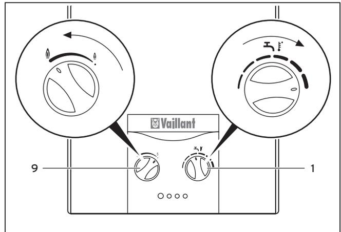
Fig. 5.2 Impostazione della massima temperatura e potenza
