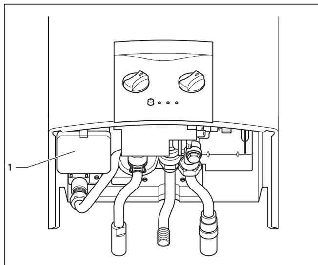
Fig. 4.15 Cambio batteria (è raffigurato l'apparecchio XI)
