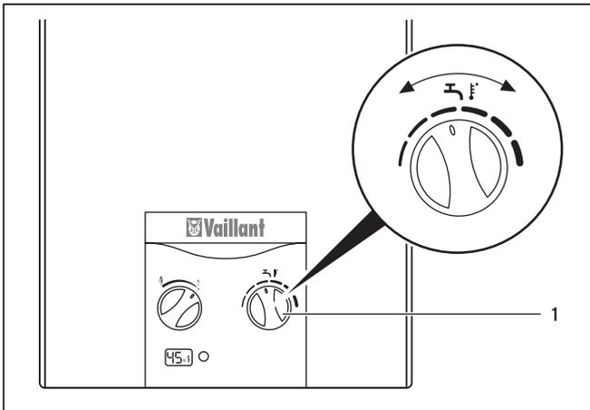
Fig. 4.8 Impostazione della temperatura dell'acqua con apparecchio GX
