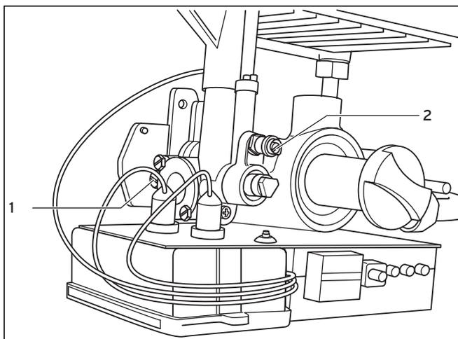
Fig. 6.1 Bocchettone per la misurazione della pressione di allacciamento del gas (è raffigurato il tipo XI)
