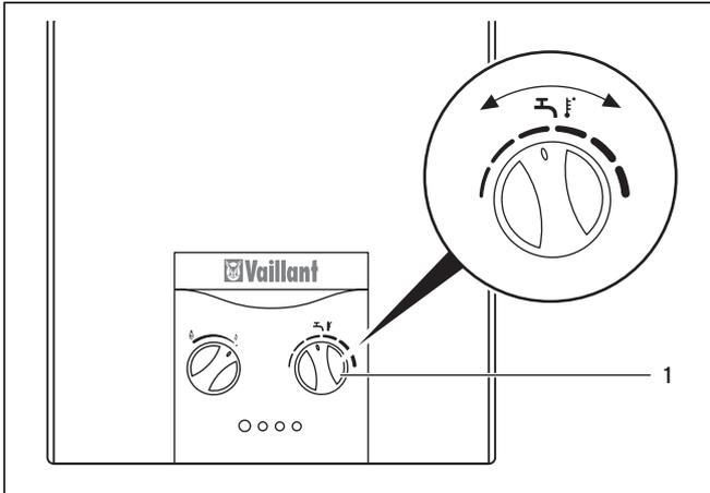
Fig. 4.7 Impostazione della temperatura dell'acqua con apparecchio XI
