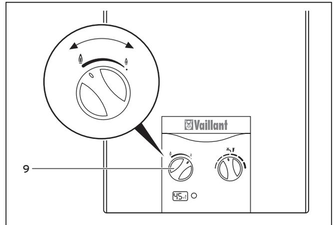
Fig. 4.10 Preselezione della potenza per apparecchio GX
