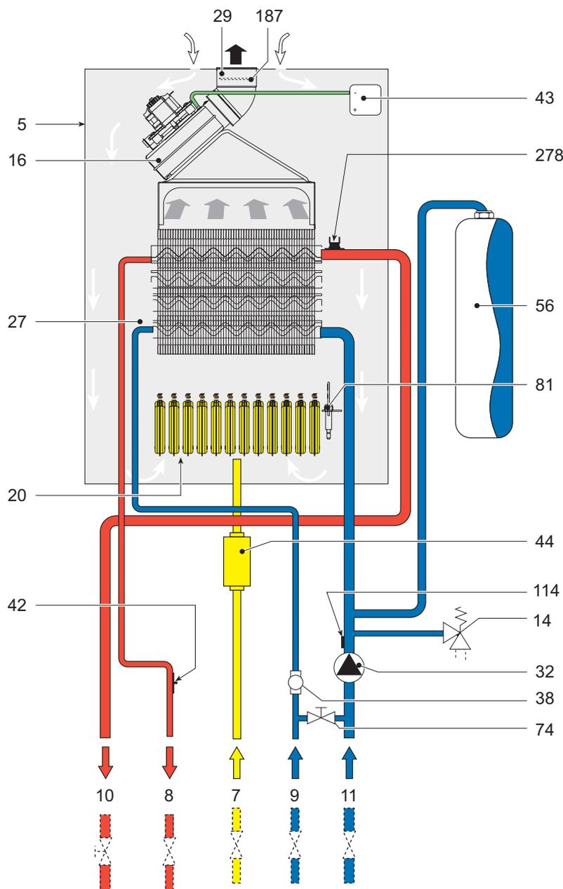
fig. 20 - Circuito idraulico
